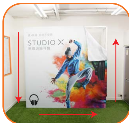
2a. 將膠邊順時針方向從左上開始 卡進布坑，直至畫布所有邊角 完全固定
